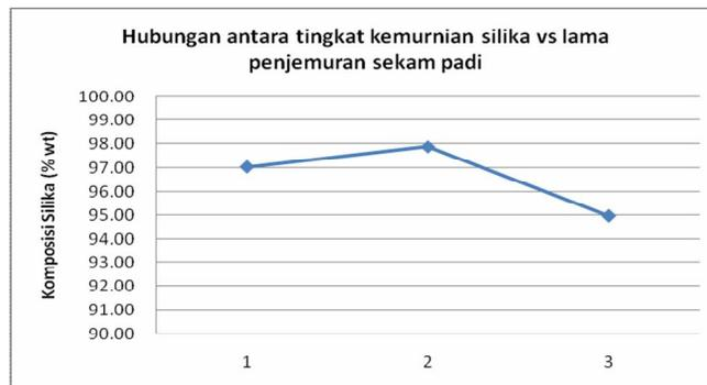
Gambar 3.2 Persentase komposisi kimia silika dengan pengujian XRF
