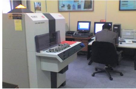
Gambar 2.4 Pengujian XRF
